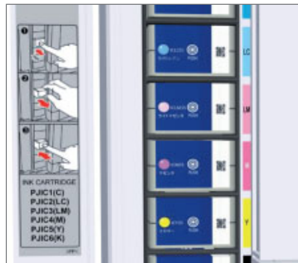
Los cartuchos individuales para los seis colores se cambian fácilmente en unos cuantos segundos e independientemente unos de otros.
